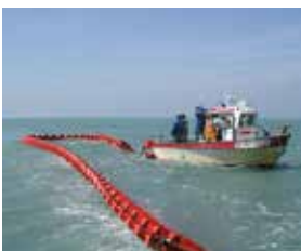
Foto de portada: Contención y recuperación con una barrera flotante © Cedre
