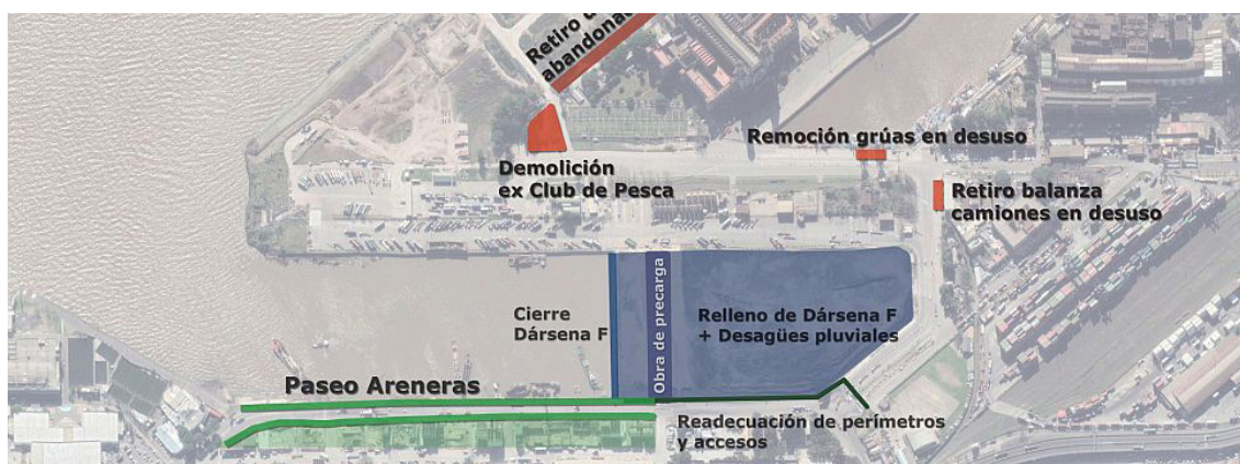
Obras de contención, relleno, liberación de interferencias y paseos urbanos (ejecutadas o en ejecución) ©Puerto Buenos Aires
