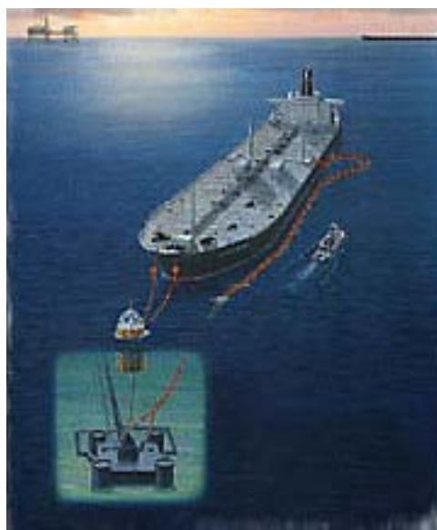
Figura 29. Diversas fotografías de petroleros atracados a monoboyas de amarre y descarga.
