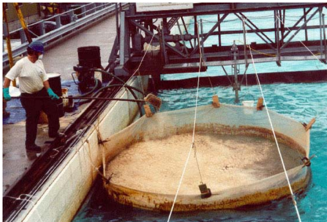
Figura 43. Tratamiento con "sorbents". Los "sorbents" absorben el petróleo del agua mediante absorción o adsorción.
