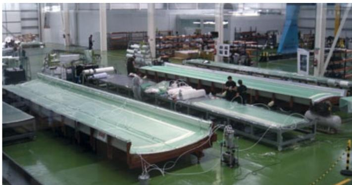
En el proceso de fabricación, primero se colocan las telas sin impregnar en el molde, a continuación se coloca el núcleo de la pieza para posteriormente disponer las capas de fibra. Una vez realizado este proceso se inyecta la resina por vacío y se le proporciona temperatura.
