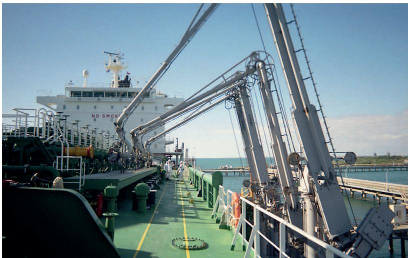
**Figura 3** – Brazos de carga duros conectados a los colectores del buque
