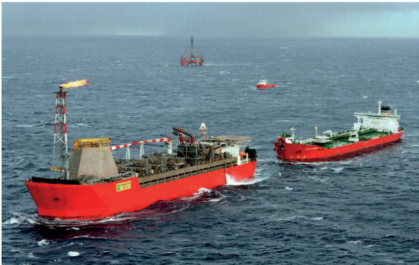
**Figura 10** – *Unidad flotante de producción, almacenamiento y descarga*
