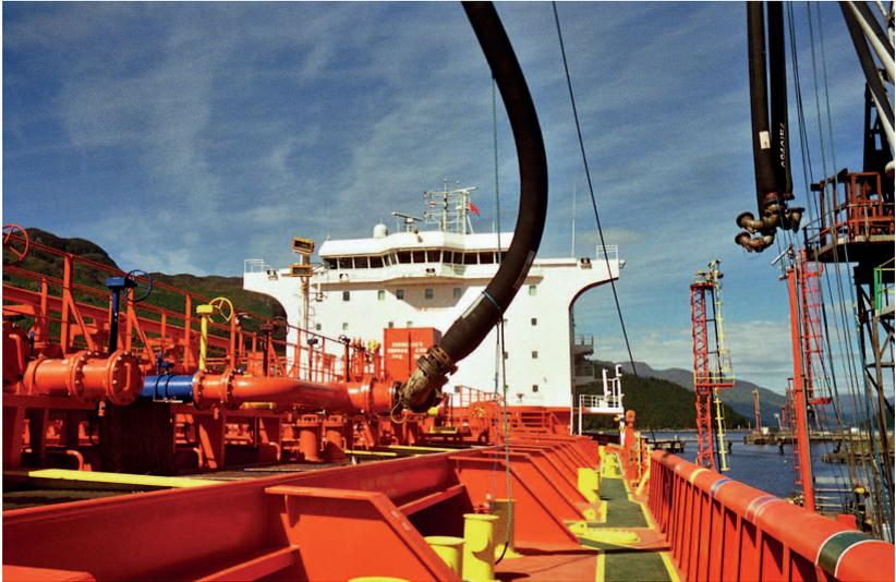
**Figura 1** – Conducto flexible de descarga de petrolero a grúa
