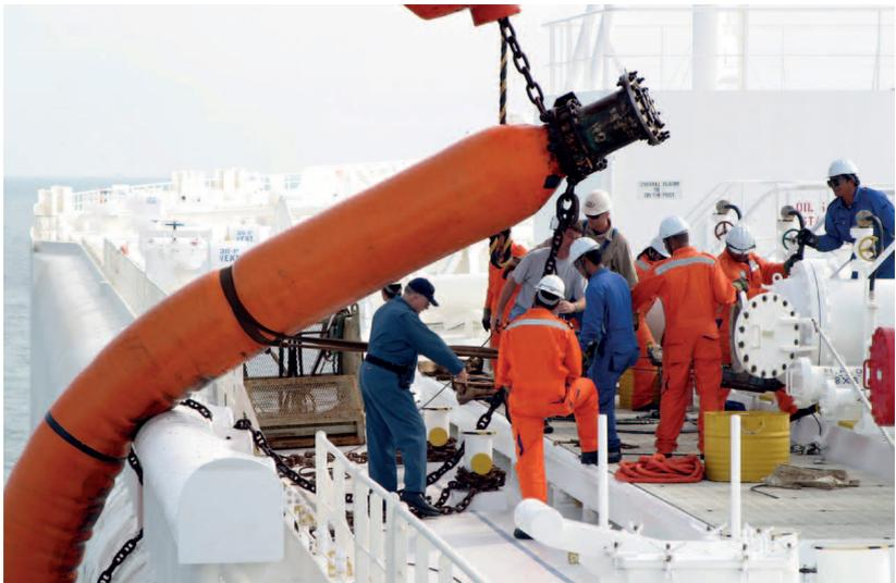
**Figura 7** – Instalación de conducto flexible durante la preparación de una operación de trasvase (Fuente: OCIMF)
