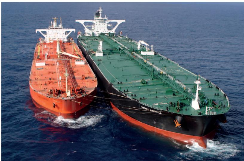
**Figura 8** – Preparación para el trasbordo de buque a buque
