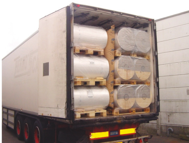
Figura 28 Relleno entre las filas de carga
