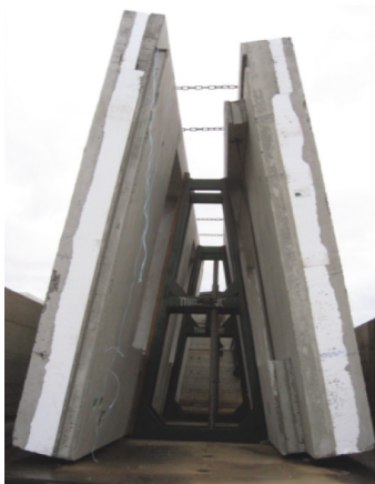
Figura 46: Bastidor móvil en forma de A
