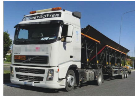
Figura 14: Chapas de acero transportadas a 45°
