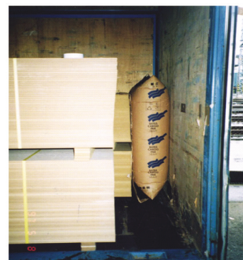
Figura 29: Colchón de aire para bloqueo lateral
