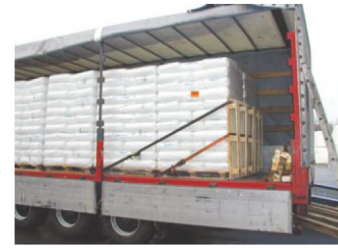
Figura 39: Sujeción con resortes mediante la utilización de palés
