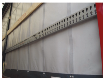
Figura 27: Listones de aluminio con orificios para barras de bloqueo
