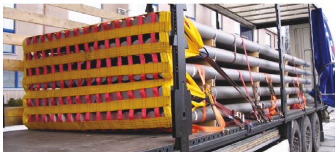
Figura 32: Sujeción con malla y amarre directo en la dirección de avance
