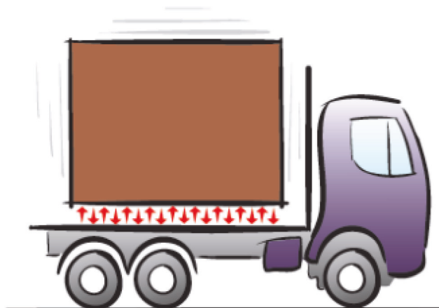
Figura 3: Vibración vertical durante la conducción
