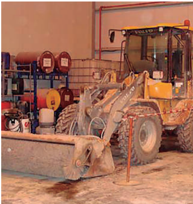
La limpieza de derrames de mercancía pulverulenta con barredoras de rodillos genera emisión de partículas.
