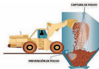
Diferencias en la ubicación y en los patrones de chorros entre inyectores que trabajan como sistemas de prevención e inyectores que actúan como sistemas de captura de polvo.
