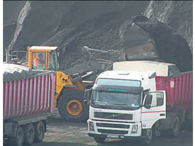
Las palas con cazo alto-volteador permiten limitar los derrames y aumentar la eficiencia de la operativa.
