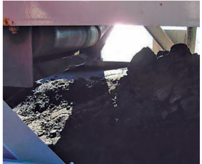
La mercancía adherida a la cinta precipita en los puntos de paso de rodillo, pudiendo ocasionar el atasco de éstos.
