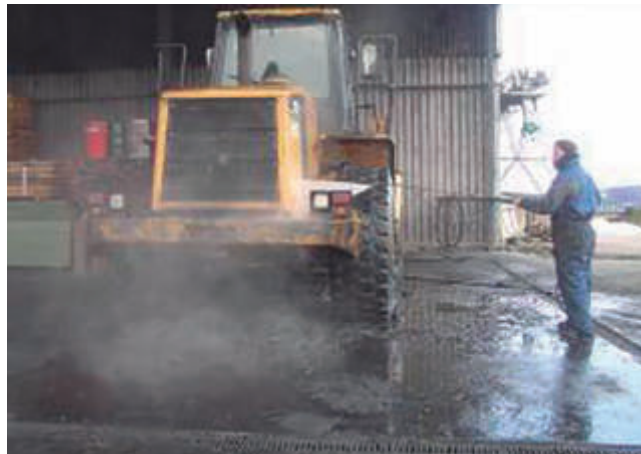
Limpeza de maquinaria en superficie con recogida perimetral de agua.
