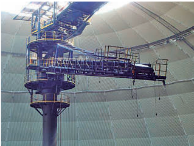
Apilador radial con sensores de elevación y sensores de presencia de obstáculos.
