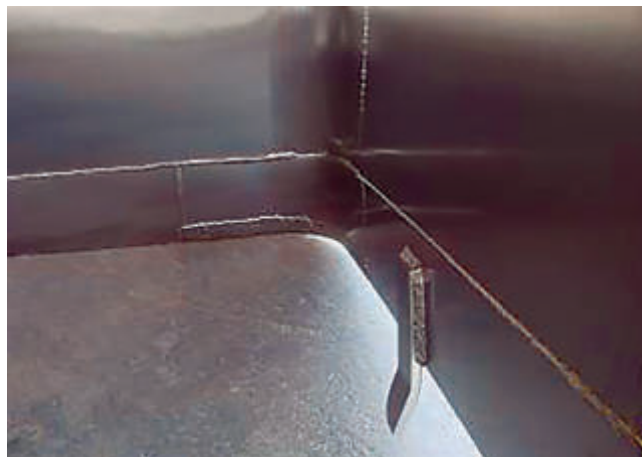
Las lengüetas en los laterales de las valvas facilitan el encuadre al cerrar las cucharas
