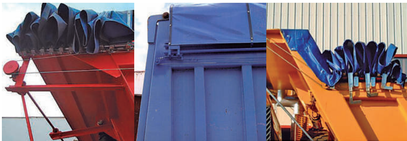
Detalles de sistemas para el plegado de toldos correderos y su correcta sujeción lateral. Raíles (izquierda), varilla (centro), cable con anclajes (derecha)
