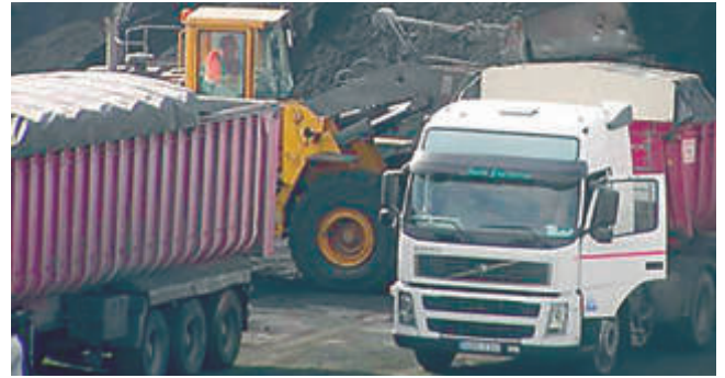
Operativa correcta. El camión es toldado en el punto de carga
