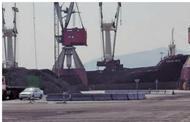
Delimitación de viales en zonas de acopio.
