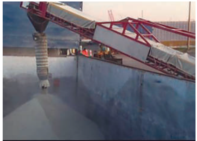
Carga de barco con cinta transportadora portátil y tolva telescópica.
