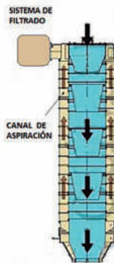
El aire es aspirado por un canal concéntrico hasta el filtro.
