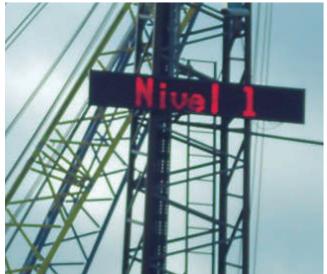
Panel informativo (andon) situado en zona de operaciones del Puerto de A Coruña.
