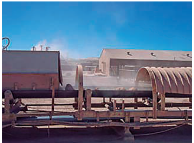
Efecto de la instalación de un sistema nebulizador en el encauzador de una transferencia entre cintas. Antes y después.
