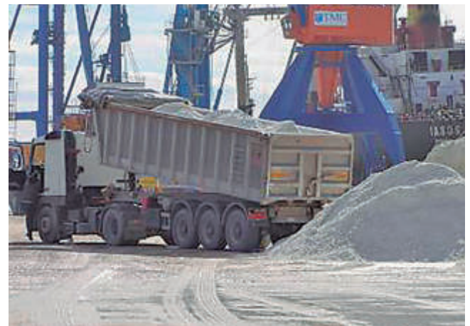
Camión retornando al punto de carga para eliminar el exceso de peso detectado en la báscula.
