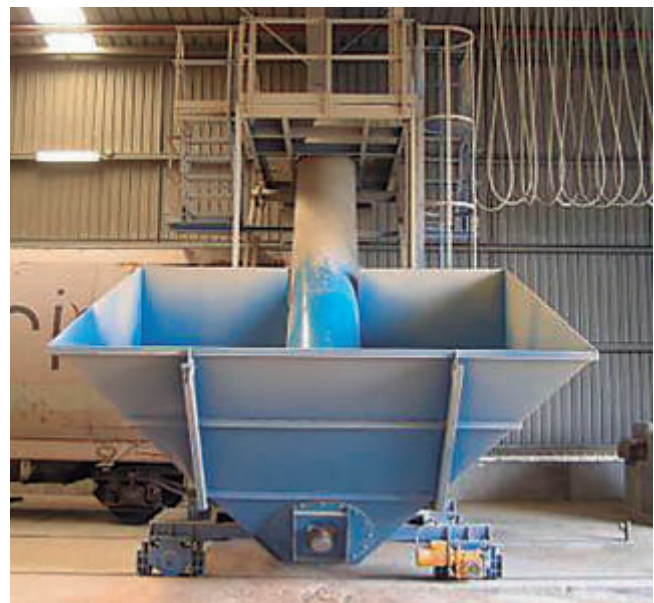
Carga mediante pala y tolva con tornillo sin fin en el interior de un almacén.
