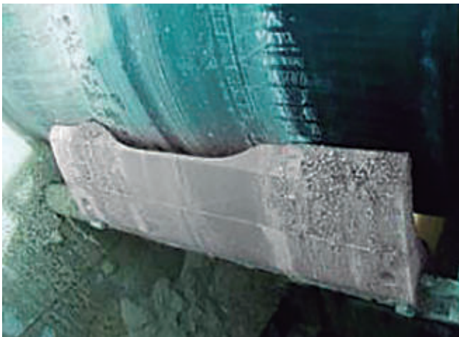
Desgaste desigual del rascador debido a una anchura excesiva.
