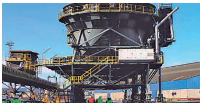
Una tolva con una boca capaz de alojar la cuchara abierta permite apantallar la acción del viento.
