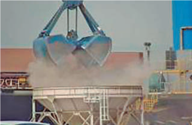
La operativa rápida de la cuchara sobre una tolva, prácticamente vacía induce una intensa corriente de aire saliente.
