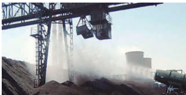
Control de emisiones mediante cañón nebulizador en descarga de cuchara sobre acopios.
