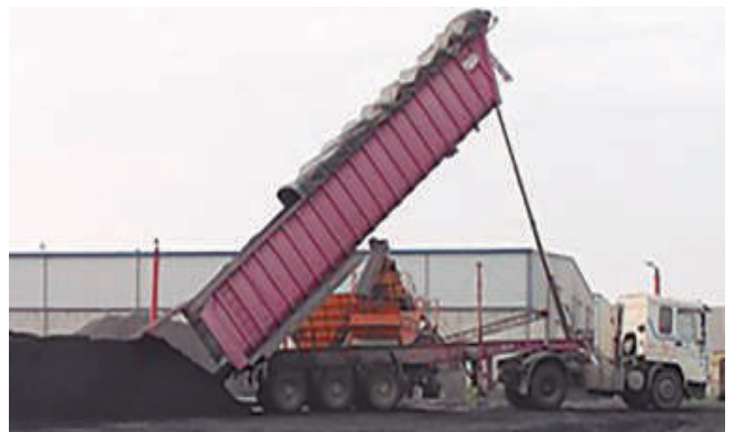
Trasporte horizontal desde muelle a parque de graneles en camión con toldo automático
