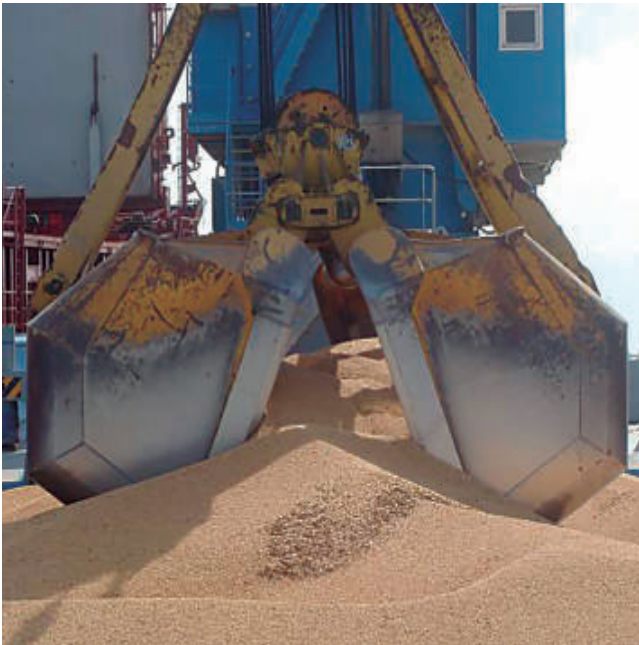
Cuchara con tapas para cereales movida por grúa móvil.
