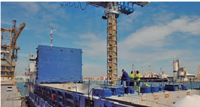
Cinta móvil de alta eficiencia ambiental con alimentador carenado con aspiración, elevador carenado, y descarga con tolva telescópica de cascada.
