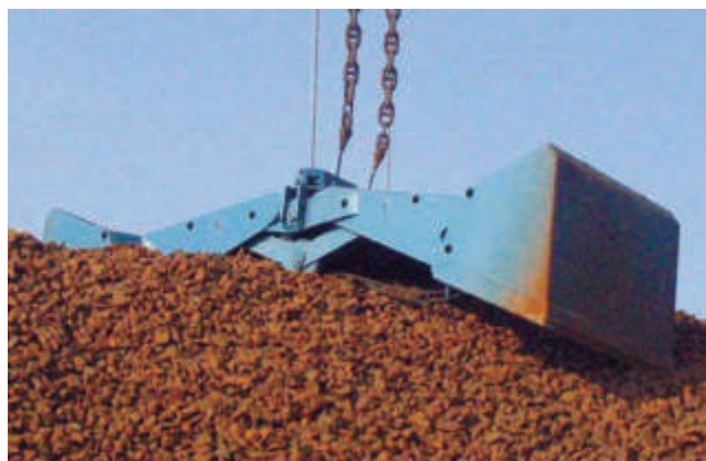
Cucharas de tijera para mover mercancías muy cohesivas o densas, que requieran gran fuerza de penetración, como es el caso del concentrado de cobre.
