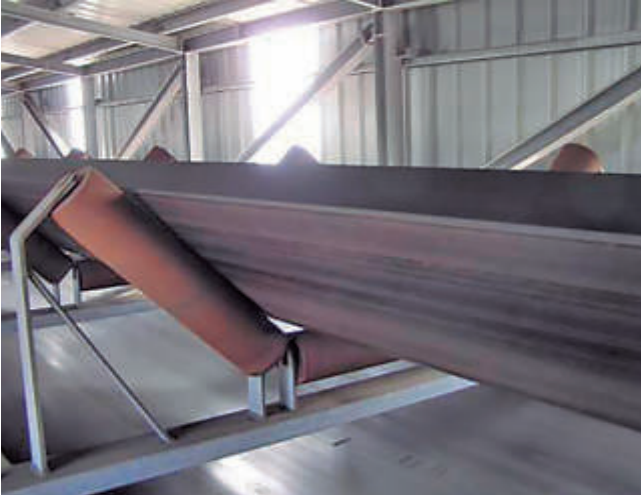
La anchura, el ángulo de cierre y el espacio entre rodillos son claves a la hora de minimizar el riesgo de derrames en cintas.
