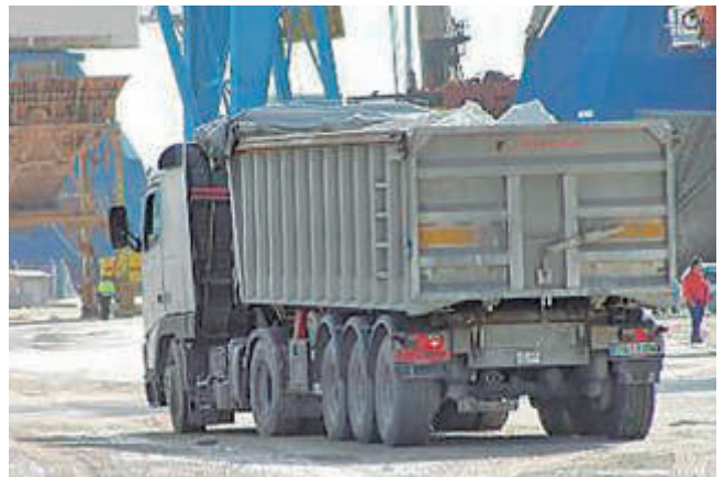
Caja de camión sin toldar y dispersión de la mercancía por rodadura.
