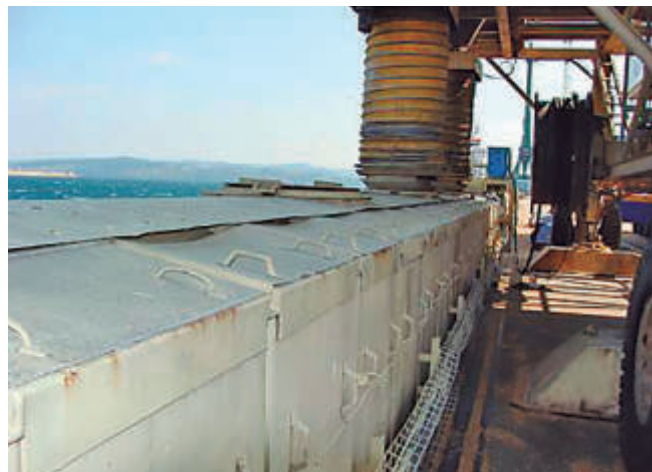
Transferencia entre tolva y cinta carenada mediante manga telescópica.
