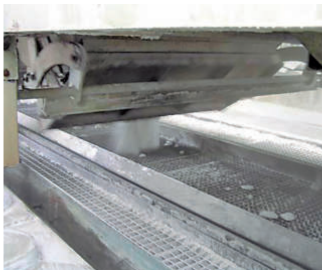
La emisión de polvo de mercancías como carbonato sódico o cereales no puede controlarse por micronización de agua.
