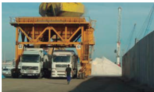
Muro móvil separando zona de operación con tolva de zona de almacenamiento.
