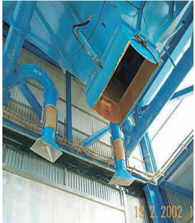
Tolva carenada con aspiración forzada, tanto en la boca de la tolva, como en el interior.
