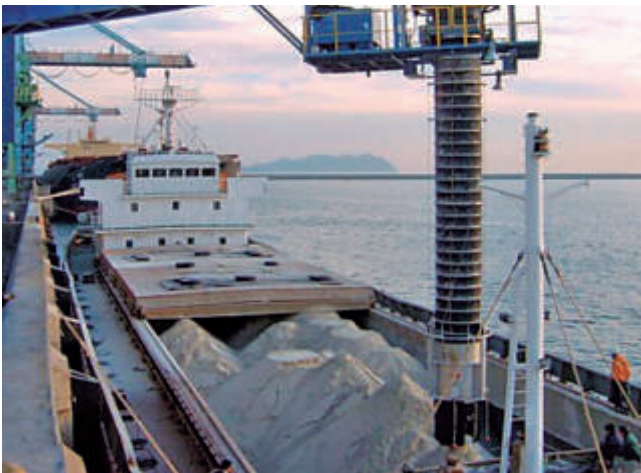
Carga de barco con pórtico cargador y tolva telescópica cerrada.
