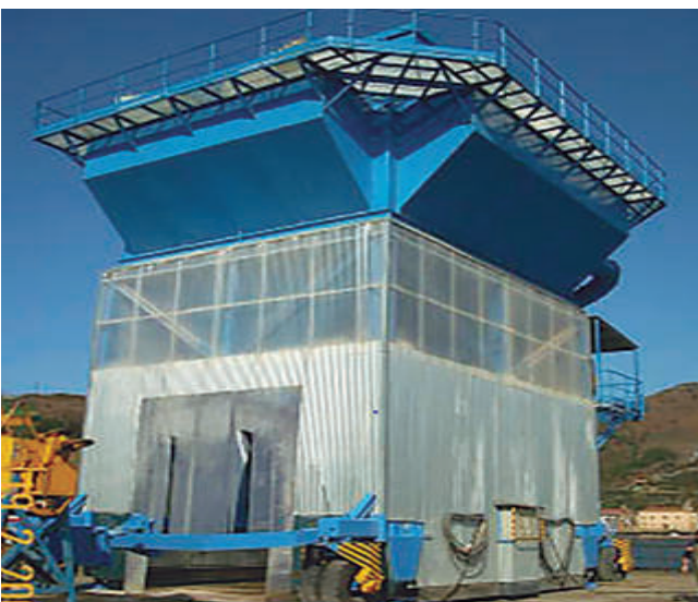
Tolva con pantallas y cortinas en el punto de carga de camiones.
