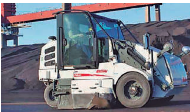
La limpieza de las zonas de transito del parque de graneles permite limitar las emisiones por rodadura.
