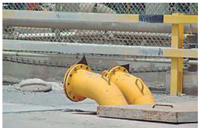
Detalle de conducción de un descargador neumático y detalle de la toma a la tubería que conecta el muelle con el almacén.
