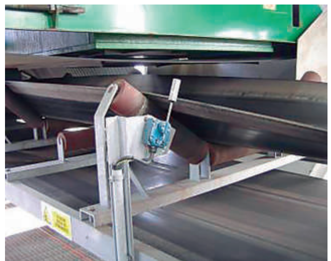
Sensor de centrado. Permite parar la instalación cuando se dan pérdidas peligrosas de alineación.
