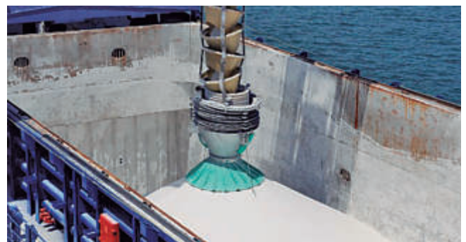
Carga de sulfato sódico con cinta móvil con alimentación aspirada y descenso en cascada.
