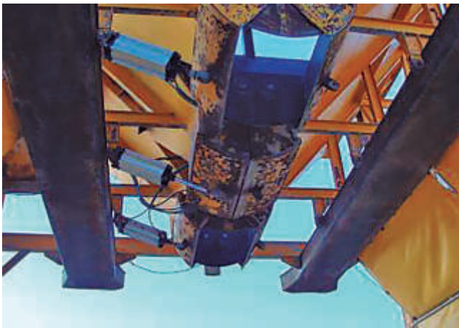
La descarga de productos fluentes a camión se realiza directamente mediante tajaderas
