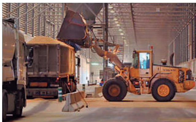
Delimitación de zona de operación con barreras móviles.
