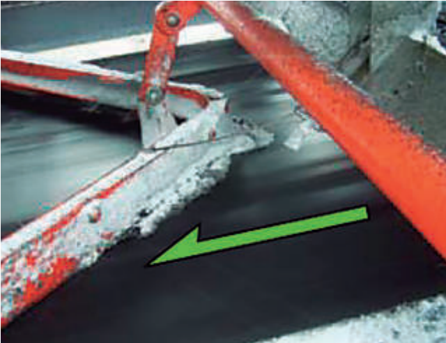
Cuña de limpieza. Elimina los restos de mercancía depositados en la cara interior.
