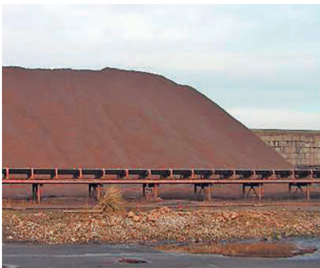
La emisión de polvo de parvas de carbón o de mineral de hierro puede controlarse mediante riego y aditivos selladores.
