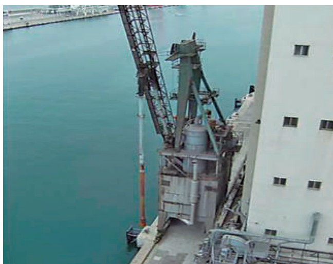
El descargador neumático (izquierda) y el cargador continuo con manga de descarga (derecha). El dimensionamiento adecuado de la capacidad de operación de los equipos permite compatibilizar rendimientos y desempeño ambiental.
