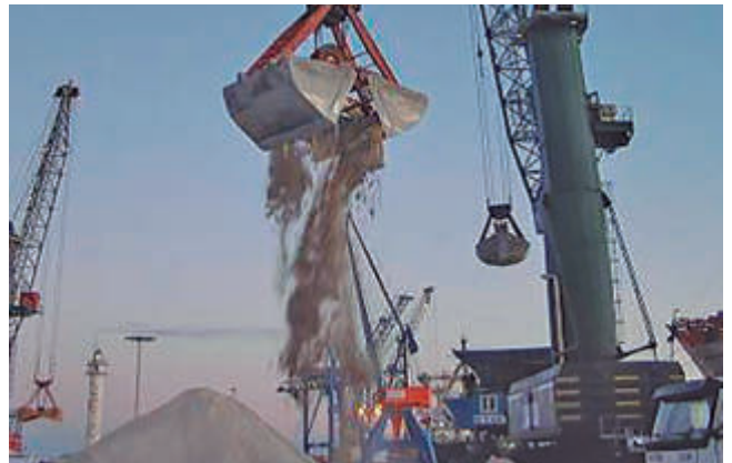
La cuchara se abre totalmente muy rápido y a gran altura, dando lugar a la mezcla de aire y mercancía.
