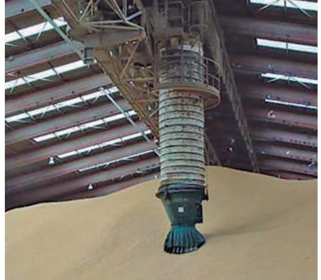
Atmósfera libre de polvo en descarga de trigo en almacén mediante cinta cenital, tripler y tolva telescópica de cascada.
