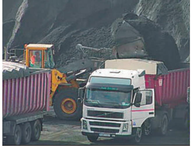
Levante de carbón mediante pala de alto volteo y camión. La pala vierte encajando parcialmente en la caja y los camiones abandonan la zona de trabajo toldados
