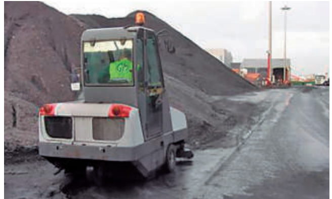
Los arrastres por rodadura pueden reducirse con una buena limpieza de la zona de operaciones.
