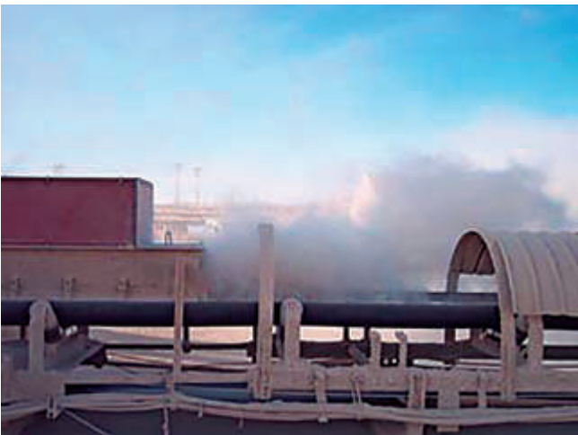
Efecto de la instalación de un sistema nebulizador en el encauzador de una transferencia entre cintas. Antes y después.
