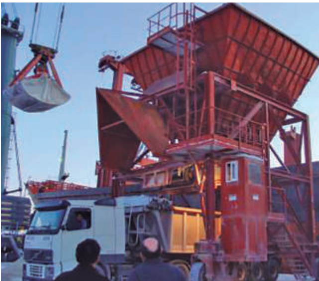
Descarga con grúa-tolva-camión.
