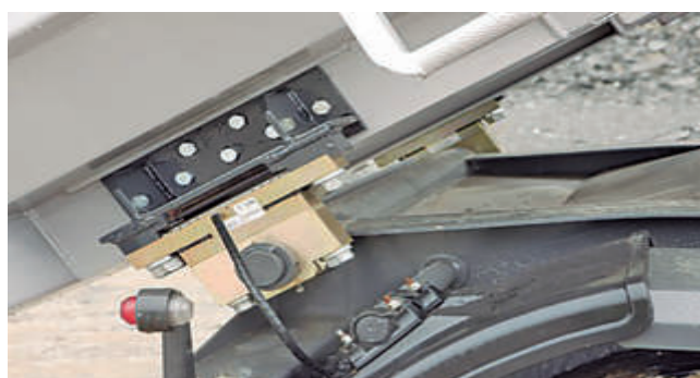
Camión con pesaje a bordo. Sensor de presión instalado en la caja basculante
