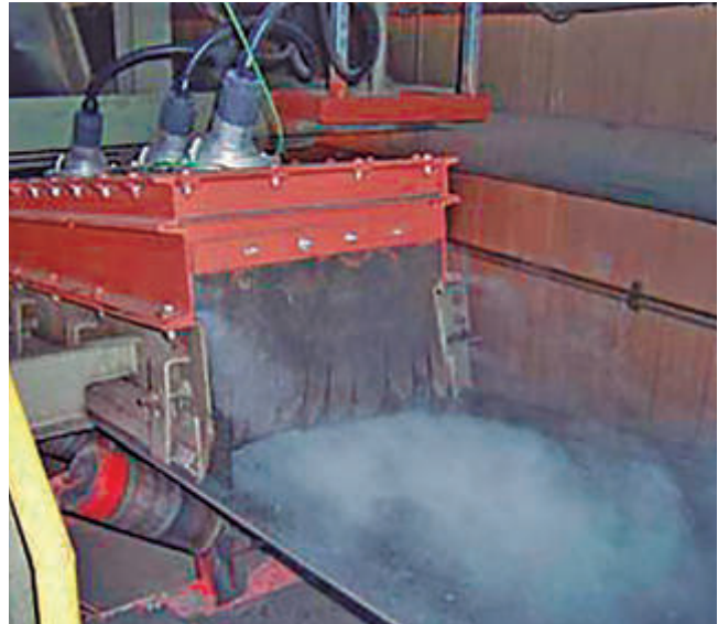
Nebulizadores en punto de vertido y en el encauzador de una transferencia entre cintas
