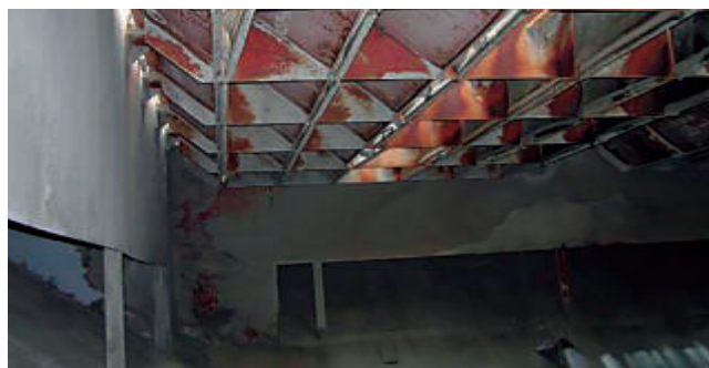
Ventanas laterales de aspiración en el interior de la boca de una tolva "ecológica".
