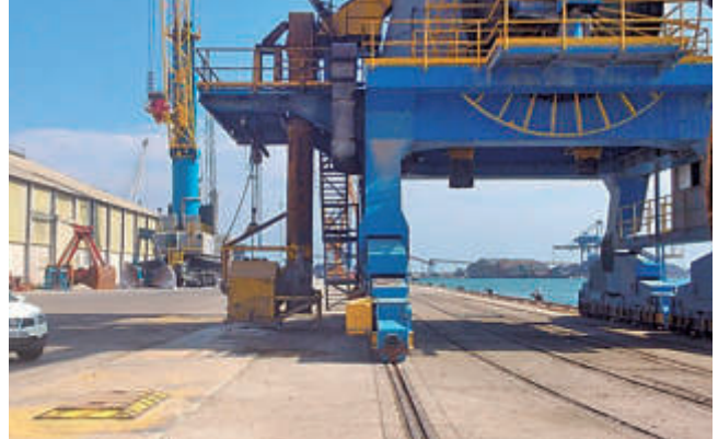
Cabezal de descargador de tornillo y transferencia a cinta en galería subterránea.
