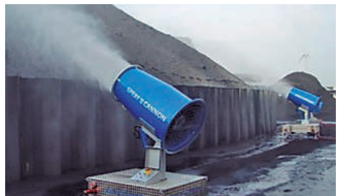
Turbinas pulverizando agua sobre acopios.
