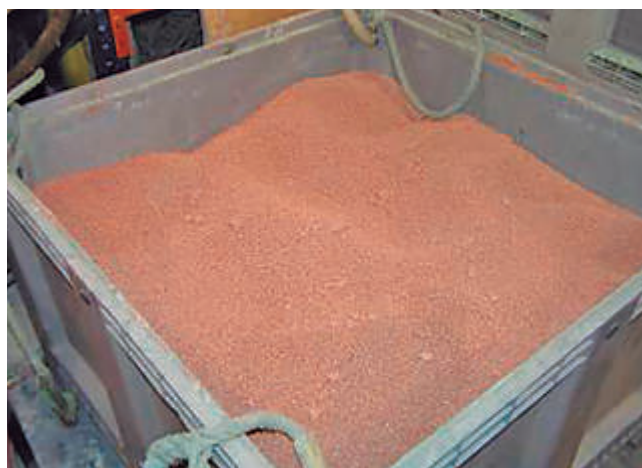
Los mantenimientos realizados in-situ deben hacerse contando con cantidades adecuadas de materiales absorbentes.
