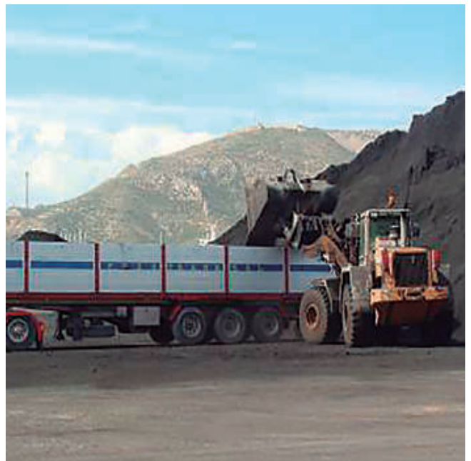
Las palas con cazo de alto-volteo desacoplan la maniobra de avance de la maniobra de vertido, con lo que se consigue un mayor rendimiento, así como un mejor control de derrames y emisiones.
