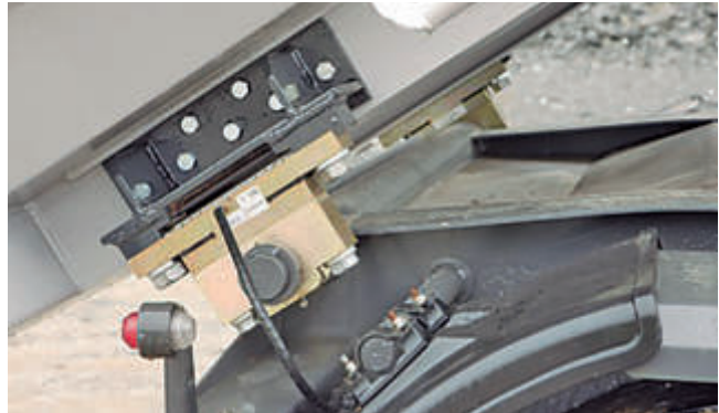
Camión con sistema de pesado a bordo.
