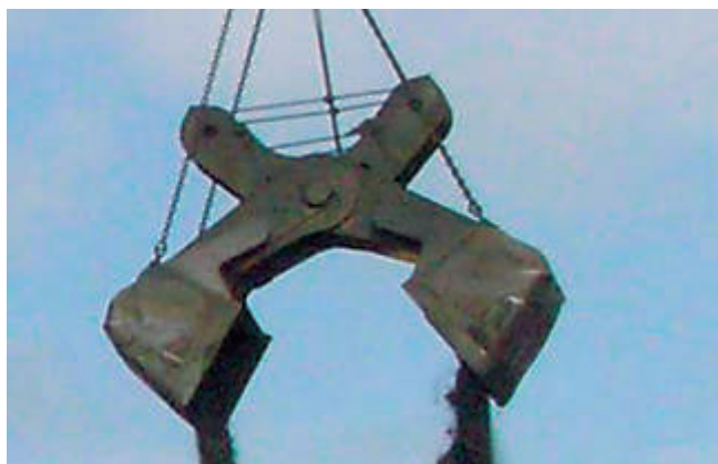
Cucharas de tijera para mover mercancías muy cohesivas o densas, que requieran gran fuerza de penetración, como es el caso del concentrado de cobre.
