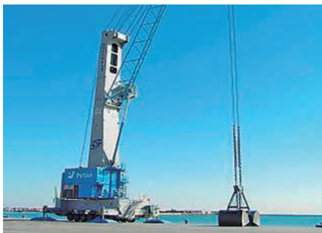
Las grúas electromecánicas reducen el riesgo de vertidos accidentales de aceites hidráulicos.
