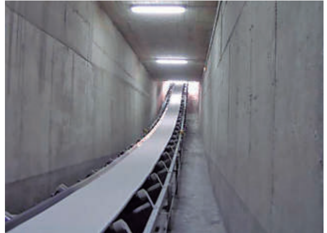
Anchura y pendiente de la cinta, adaptadas a las propiedades de densidad y fluidez del material (carbonato sódico). Puerto de Santander.
