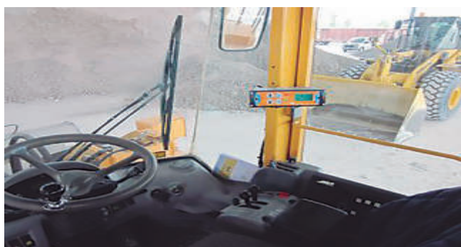
Pala cargadora con pesaje de cazo a bordo y control de la carga total vertida
