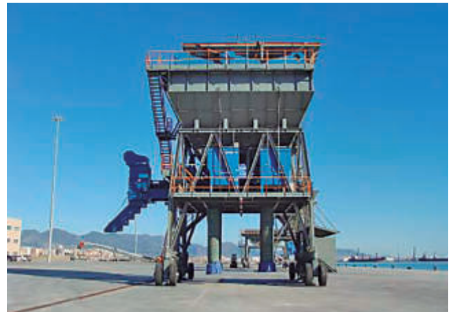
Tolva dotada de carga de cintas y de camiones con aspiración forzada.
