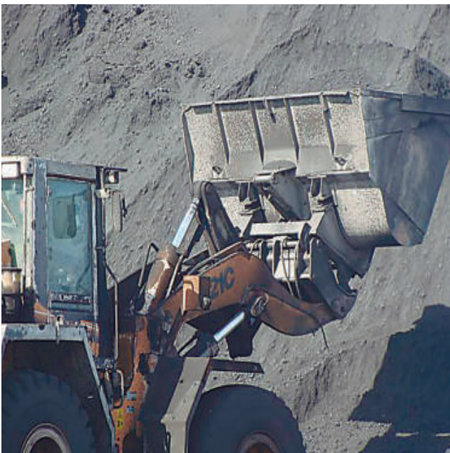
Las palas con cazo de alto-volteo desacoplan la maniobra de avance de la maniobra de vertido, con lo que se consigue un mayor rendimiento, así como un mejor control de derrames y emisiones.
