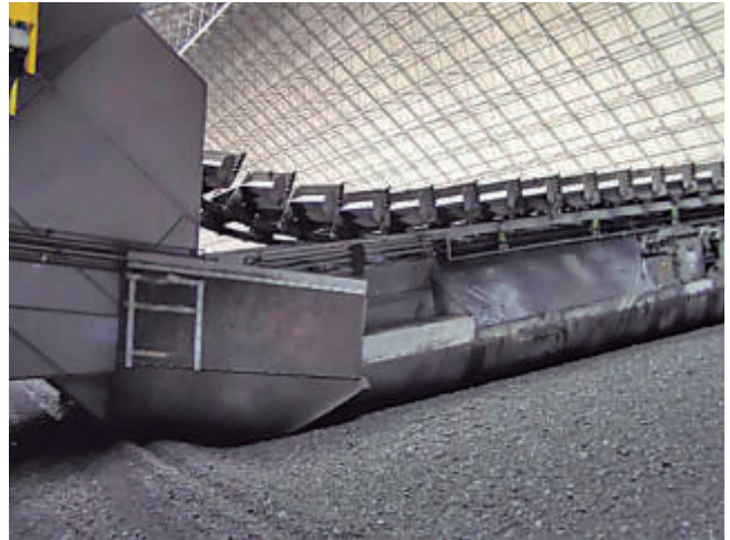
Recogedor lineal de cadenas con faldones.
