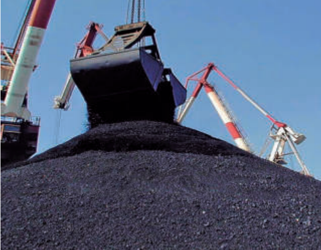
Acopio de carbón en primera línea. La cuchara abre lentamente casi en contacto con la parva para limitar emisiones.
