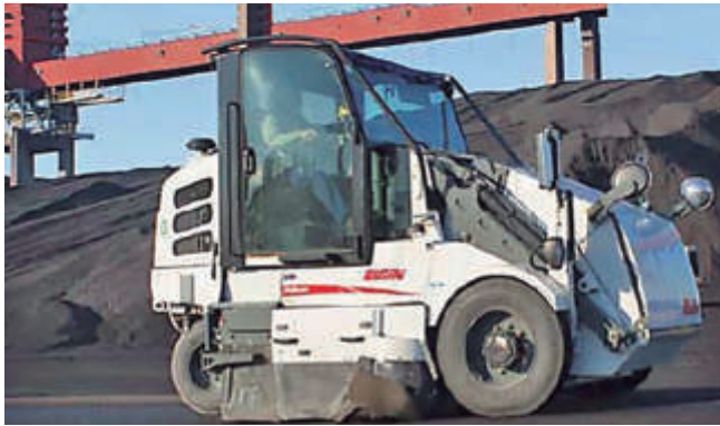
Barredora con sistema de supresión de emisiones de polvo por nebulización de agua.
