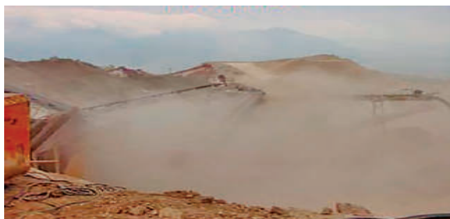
Implantación de un sistema de pulverización de agua con aditivos tensoactivos en transferencias de cintas. Antes y después.
