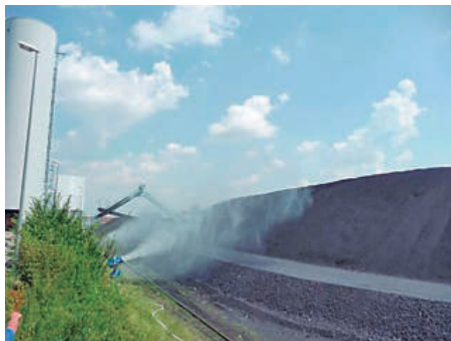
Control de emisiones polvo en acopios con turbinas de agua atomizada
