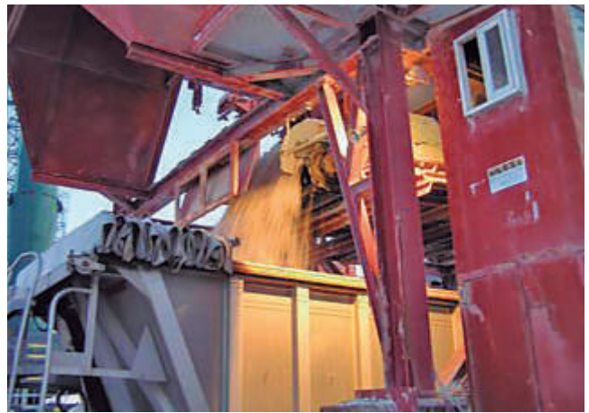
Las tolvas para productos adherentes realizan la descarga mediante cintas situadas en la base
