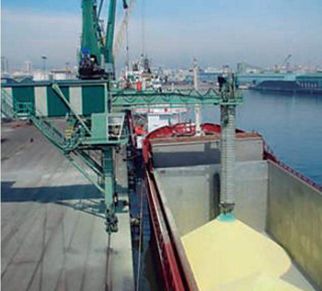
Adecuado control de emisiones en la carga de azufre con tolva telescópica de cascada.
