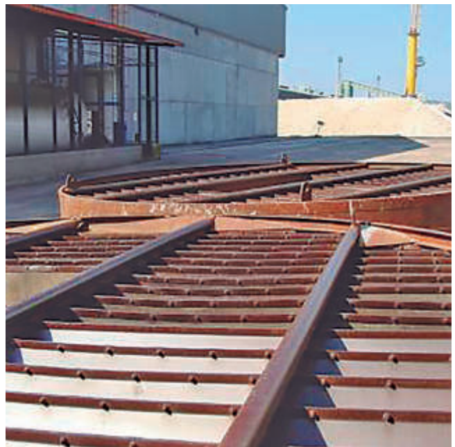
Las rejilla Flex-Flap reducen la salida de polvo en la boca de tolva.
