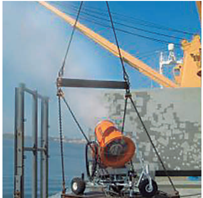
Las turbinas atomizadoras pueden apoyar la carga/descarga de barcos
