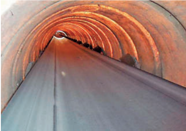
Cinta con capotado superior con elementos abatibles.
