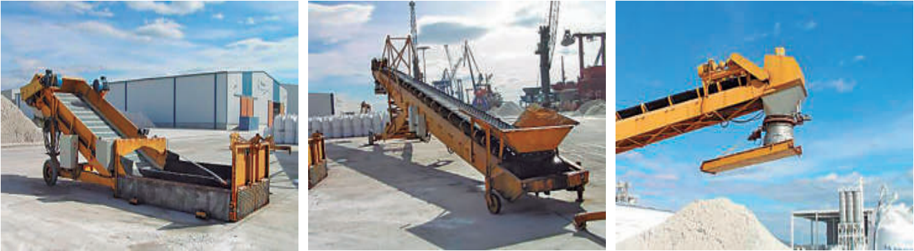
Cinta móvil tradicional: Elevador, Tobogán y Alimentador
