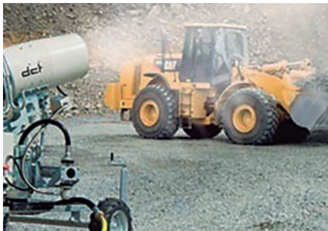
Turbina de agua atomizada en zona de carga de camión con cuchara.
