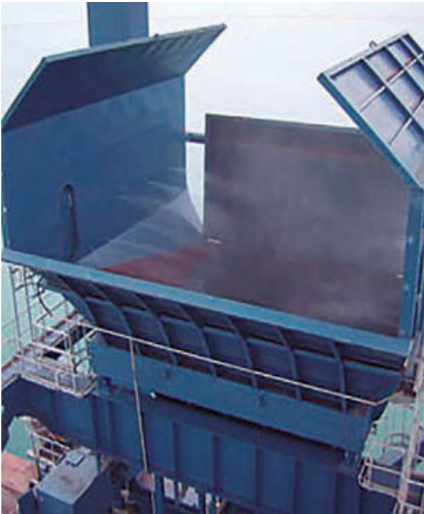
Boca de tolva apantallada con atomizadores de agua de alta presión.
