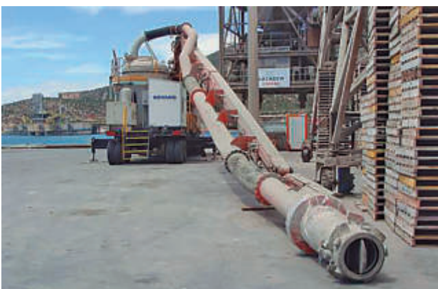
Detalle de conducción de un descargador neumático y detalle de la toma a la tubería que conecta el muelle con el almacén.
