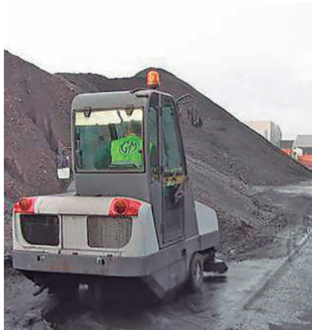
El uso de barredoras con humectación y aspiración permite controlar la emisión de polvo en la limpieza de viales.
