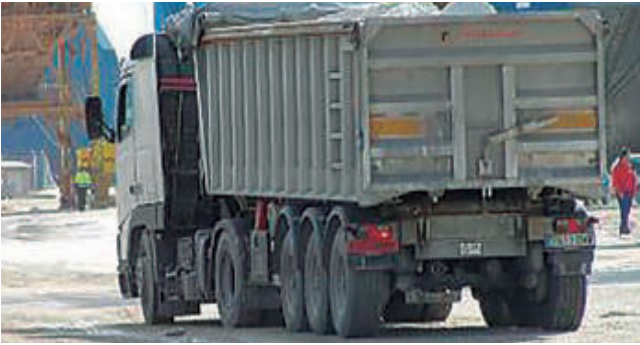
Operativa incorrecta. El camión abandona el punto de carga sin toldar.
