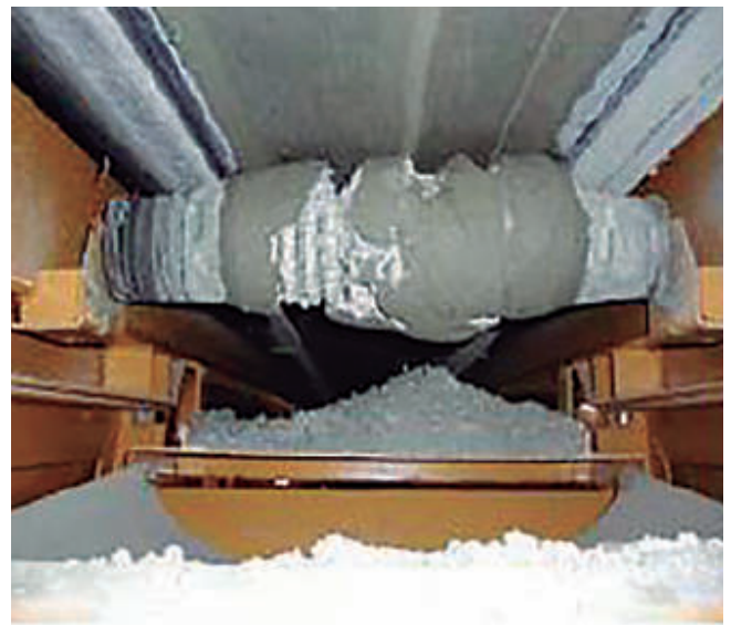
Acumulación de mercancía adherida a la cinta debajo de los rodillos.
