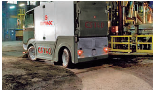
Barredora con sistema de control de emisiones por nebulización y aspiración.
