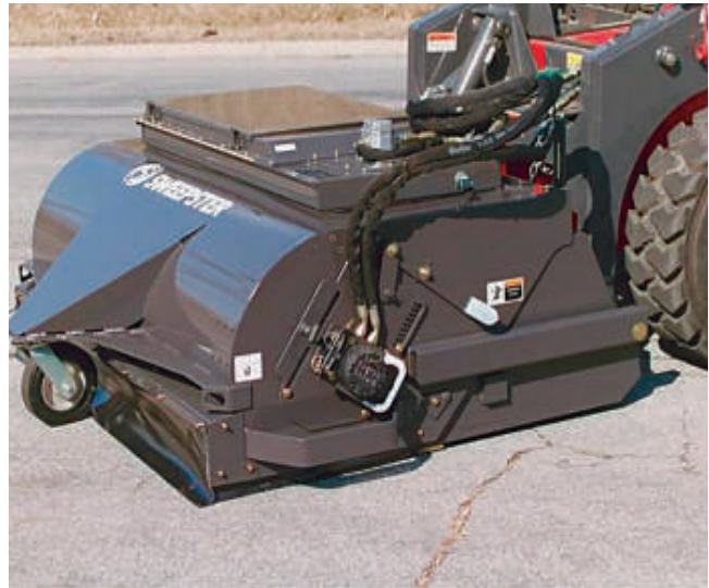
Barredoras de cepillo dotadas de recogedor carenado e inyectores de agua nebulizada para evitar emisiones de polvo, que pueden ser acopladas a excavadoras.
