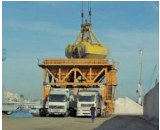
La cuchara se abre por debajo de la boca de la tolva para evitar emisiones.
