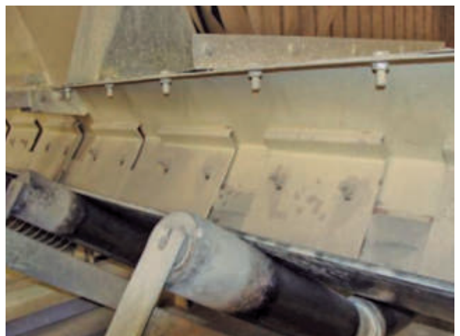
La hermeticidad en el cierre de trampillas de tolvas, y faldones de encauzadores previene la generación de derrames.
