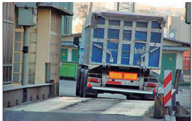
Camión abandonando la báscula oficial de salida. La instalación de básculas en puntos de carga o sistemas de autopesoado permite prevenir retornos por sobrepeso
