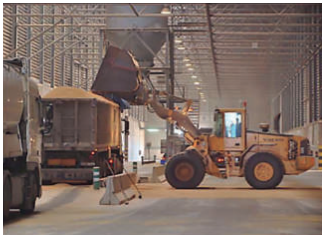
Levante de almacén con camión y pala. La zona de tránsito de camiones está separada de la zona de operación mediante barreras.
