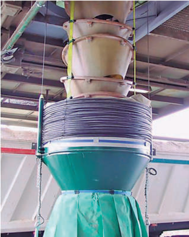
Tolvas telescópicas de cascada en cargador de camión y en cargador de barco. La corona de descarga permite limitar la dispersión de material en el punto de impacto.
