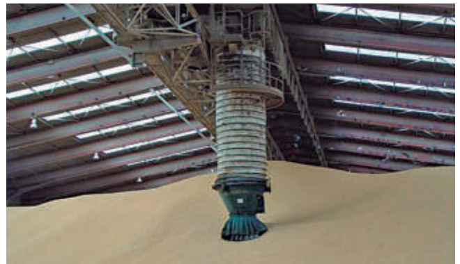
Descarga cenital desde cinta con tripper y descarga desde cinta con tripper y tolva telescópica. La tolva telescópica de cascada limita la emisión de partículas y el deterioro de la mercancía.
