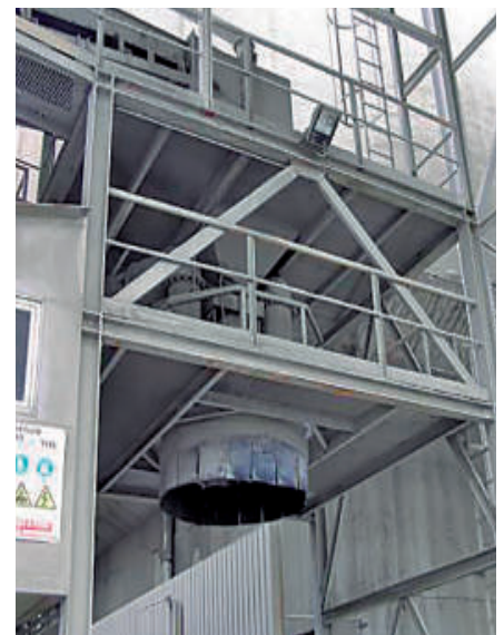
Manga con aspiración para carga de camiones
