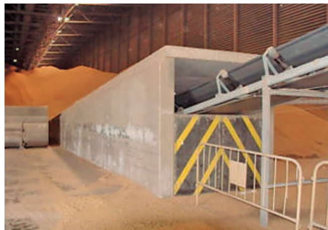
Descarga de almacén mediante tolva subterránea y cinta de evacuación subterránea en almacén de cereales
