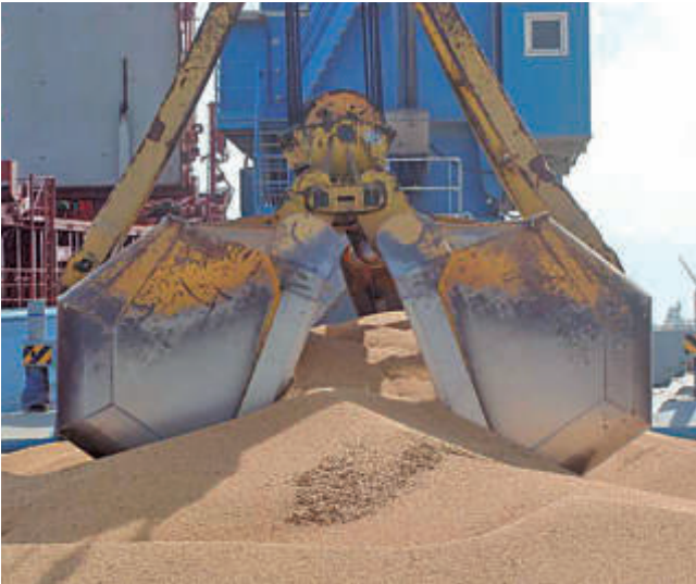
Cuchara con tapas adaptadas al movimiento de cereales
