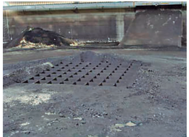
Las tolvas subterráneas pueden contar con sistemas de vibración o agitación que garantizan el flujo de la mercancía
