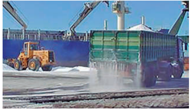
Derrames por estado no adecuado de los cierres de caja.
