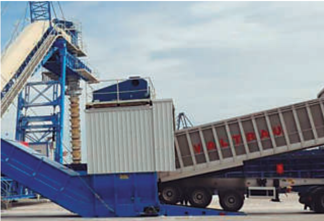
Cinta móvil con alimentador carenado.
