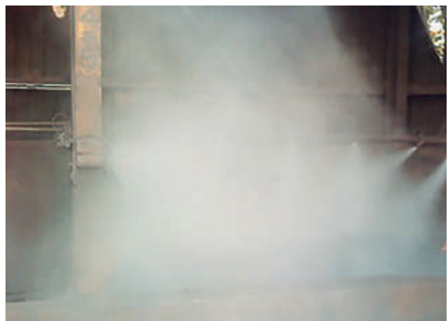
Control de emisiones en descargadero de vagones y en descargadero de camiones por agua nebulizada.
