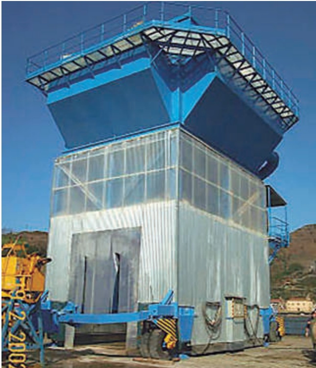
Tolva carenada con aspiración forzada, tanto en la boca de la tolva, como en el interior.
