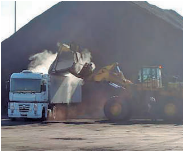
La pala vierte de modo adecuado la mercancía sobre la vertical de la caja.
