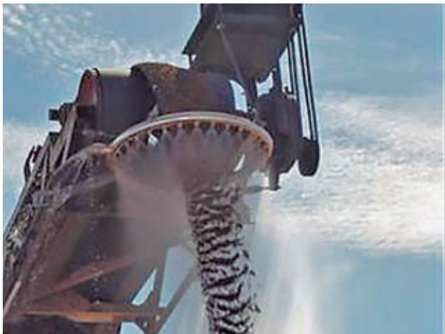
Control de emisiones de polvo en apilador con inyectores de agua atomizada.
