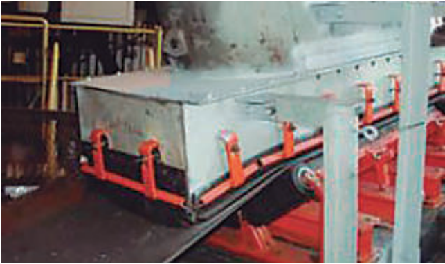
Caja selladora que evita la salida de mercancía por la parte trasera.
