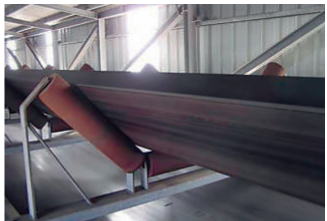
El correcto mantenimiento de rodillos evita ruidos y posibles roturas de cinta.
