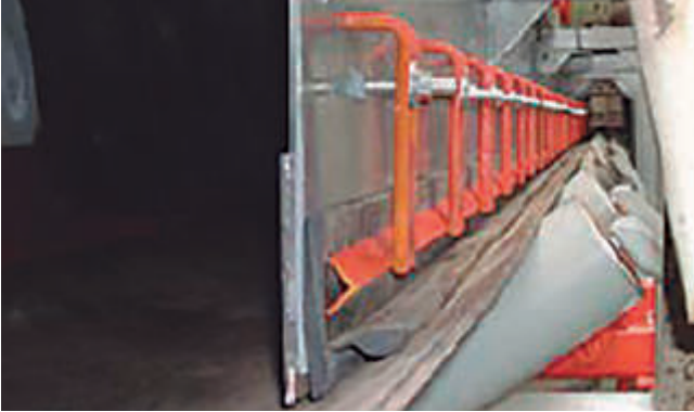
Encauzador con faldones de doble labio y banda de desgaste en el interior.
