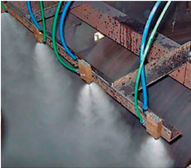
Nebulizadores en punto de vertido y en el encauzador de una transferencia entre cintas
