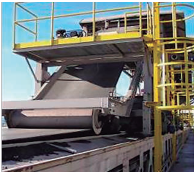
Cober Belt. La cinta está protegida por una cubierta elástica que es elevada para realizar la carga.
