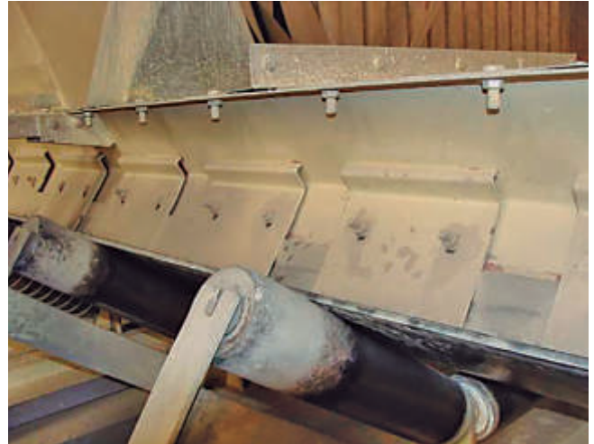
Un encauzador largo permite el asentamiento del polvo en su interior.
