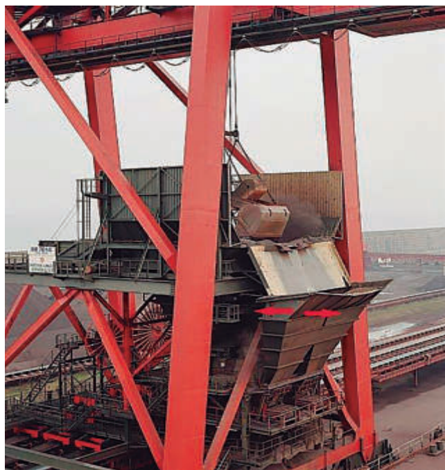
Bandejas atrapa derrames en grúa pórtico
