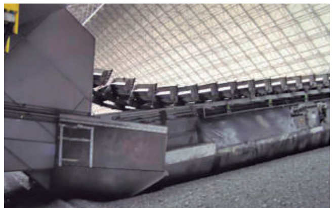
Levante de la mercancía en almacén mediante recuperador de cadenas carenado con aspiración. Los faldones y la aspiración limitan las emisiones en el proceso de recuperación de la mercancía.
