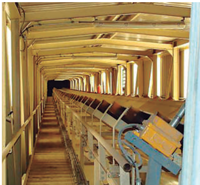
Vista interior y exterior de una cinta en galería, utilizada para el movimiento horizontal de cereales entre muelle y almacén.
