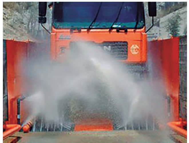
Secuencia de lavado en lavaruedas de paso continuo.
