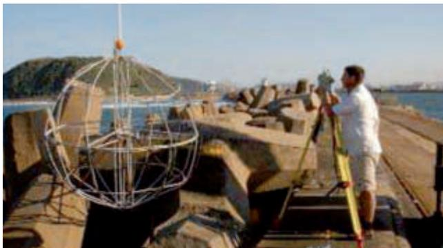
Figura 9. Seguimiento topográfico mediante el sistema de contraste con bola.
