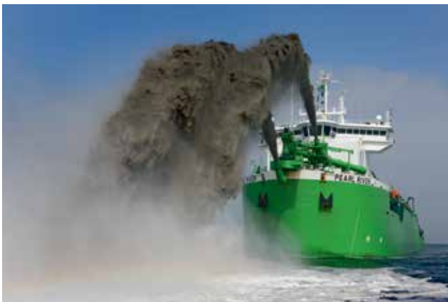
abajo. Un trailer colocando material mediante el sistema por cañón (rainbowing) con dos salidas
