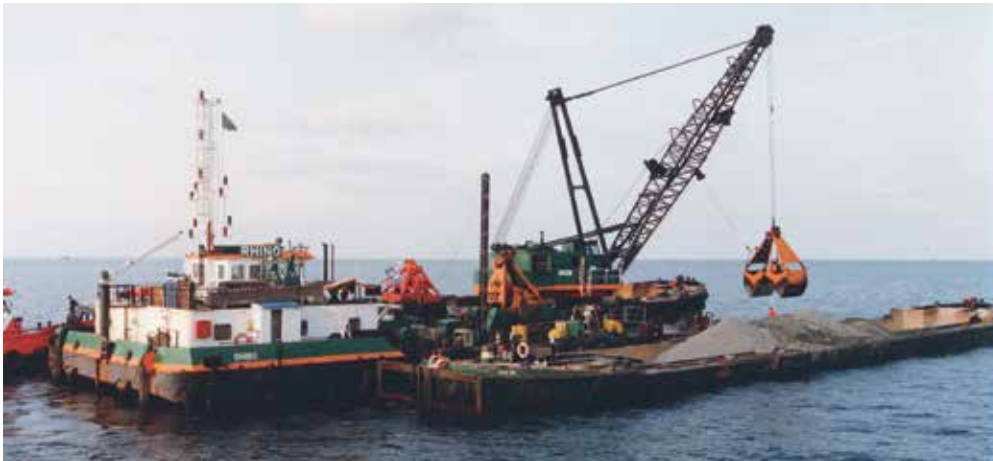
Una draga de cuchara o de almeja montada en una cabina rotatoria
