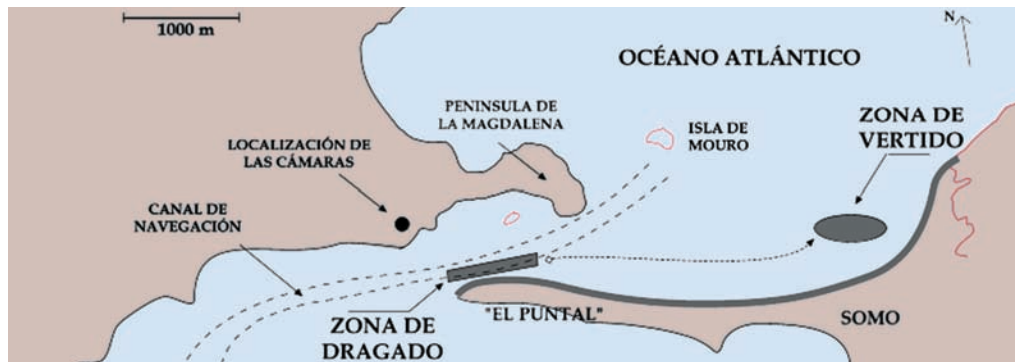
Figura 5-7. Zona de estudio y línea de límite hipotético, que una vez superada por los contornos de costa, se procede a dragar la canal de navegación.
