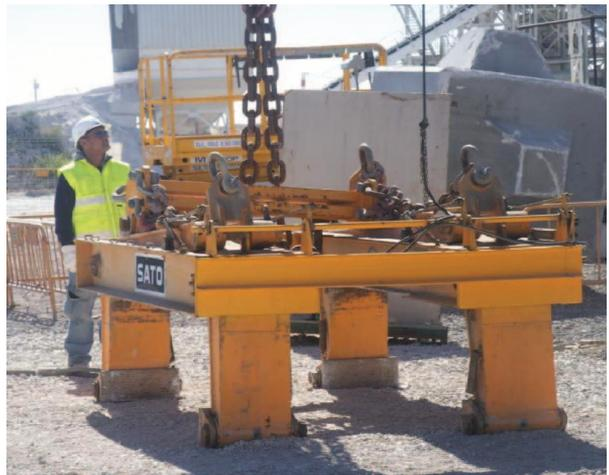
Figura 8. Pinzas doble adaptadas para la manipulación de cubípodos.
