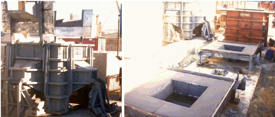
Figura 6. Elemento superior articulado, bases del encofrado del cubípodo.
