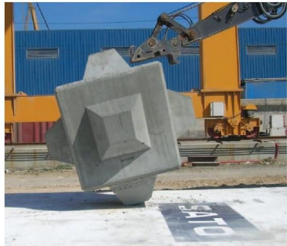
Figura 10. Volteo frontal de cubo y Cubípodo.
