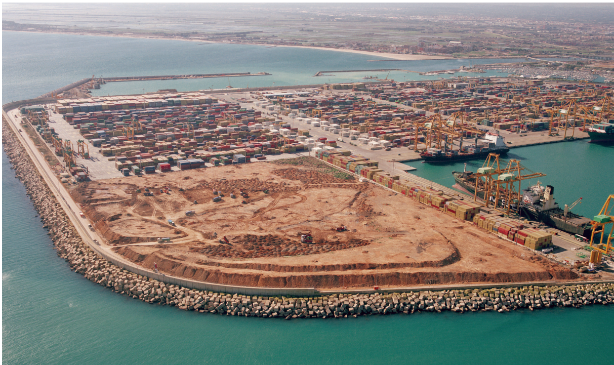
Ilustración 8. Precarga en sus últimas fases.
