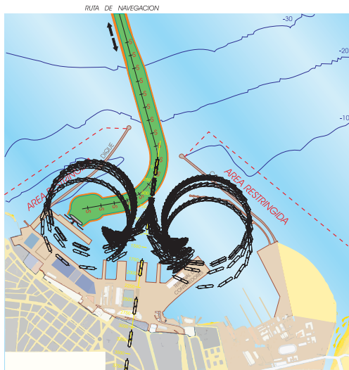
Figura 11. Situación de las maniobras de extinción natural navegando en la ruta interior 3.
